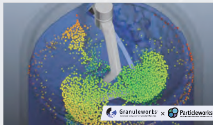
液体-粉体連成解析 攪拌槽挙動解析
