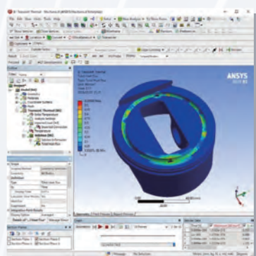
Ansys Mechanicalに 熱伝達係数を荷重としてインポート
