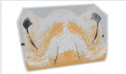
リボンミキサーによる攪拌解析
